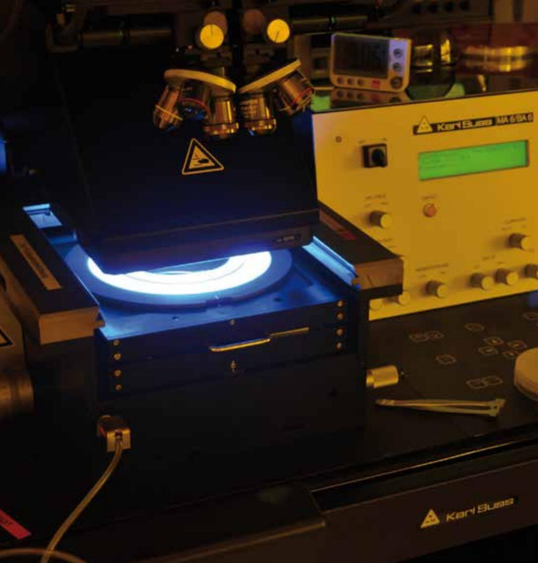
Mit dem Belichter MA 6 der Firma Karl SUSS können Strukturen aufgelöst werden, die kleiner als  $1\mu\text{m}$  sind.
